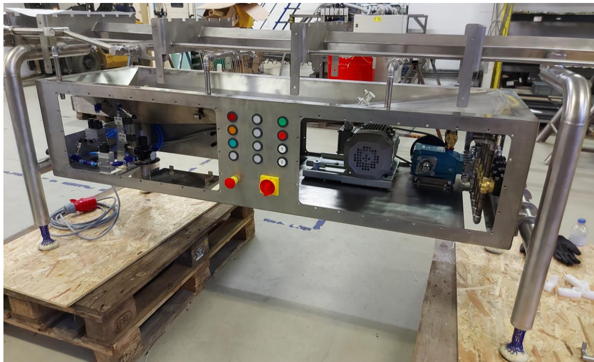
2. ábra: Vízszintes prototípus szállítóberendezés szalag tisztító egység szerelvényezés közben
