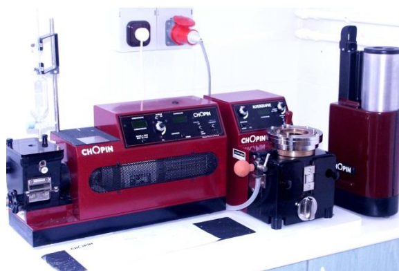
Hagberg esésszámvizsgáló készülék
